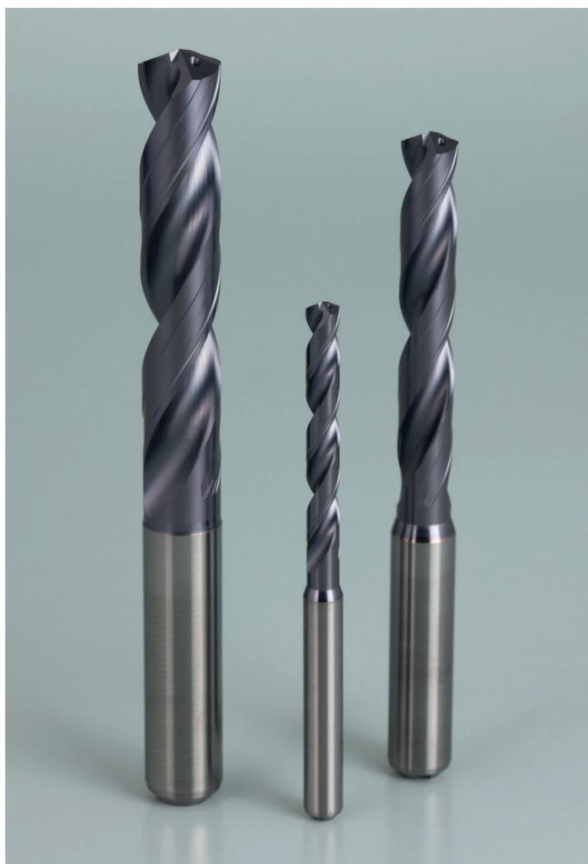
1 Der vielseitige Spiralbohrer ›Basic‹ hat eine gebogene Schneide, die kurze Späne erzeugt und sie so formt, dass sie leicht durch die Nut aus der Bohrung abgeführt werden können
